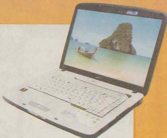
Processador Intel Celeron 560 (2.13Ghz, 533Mhz, 1mb L2); Tela de 15,4" WXGA; Memória 1024Mb DDR-2 667Mhz; Placa de Video Intel Graphic X3100; HD de 120Gb; Gravador de DVD; Placa de Rede 10/100Mbps; WebCam Integrada; Wireless Lan 802.11b/g; Leitor de cartão de memória 4 em 1.
