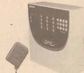
CENTRAL DE ALARME
