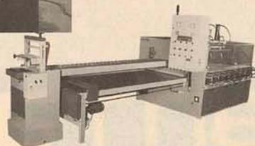
**Prensa Coladeira Múltipla:** alta frequência para painéis: As Pressas e Coladeiras Múltiplas produzidas pela Metrisa são de construção robusta, para colagem de sarrafos e na produção de painéis maciços. A secagem da cola é efetuada por meio de ondas de rádio frequência com gerador de 15 a 120 kw de potência.
