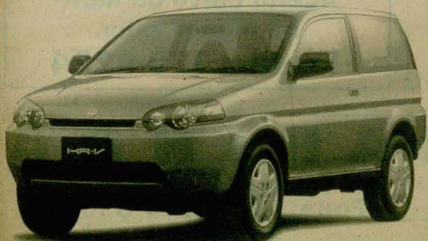
Honda HR-V é um fora de estrada em escala menor. Com tração nas quatro rodas, este moderno jipinho é equipado com motor 1.6 e dotado, opcionalmente, de sistema de câmbio de variação contínua, que passa automaticamente da tração dianteira para a total ao menor sinal de perda de aderência.
