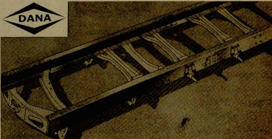
**Simesc Parish**. Há mais de uma década a Wiest, através da Simesc, vem fornecendo a clientes especiais, como a Volvo, Scania, Ford e Volkswagen, as longarinas para chassi de caminhões e ônibus.
