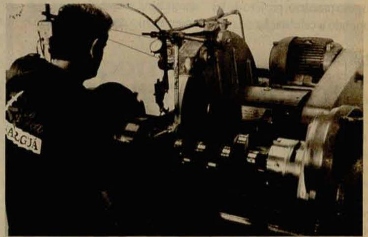
Alta precisão na retífica dos componentes dos motores
